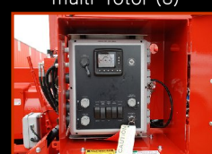
Sistema de control integrado con monitor
